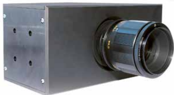
РОСЭЛЕКТРОНИКА СОЗДАЛА ИНФРАКРАСНУЮ КАМЕРУ С ДАЛЬНОСТЬЮ ОБНАРУЖЕНИЯ ДО 20 КИЛОМЕТРОВ
