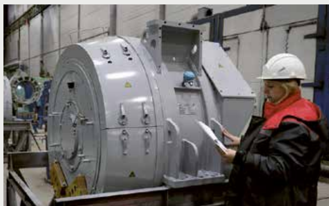
ОПЫТНЫЕ ОБРАЗЦЫ ТЯГОВОГО СИНХРОННОГО ГЕНЕРАТОРА ПРОИЗВОДСТВА ТМХ-ЭЛЕКТРОТЕХ УСПЕШНО ПРОШЛИ ПРЕДВАРИТЕЛЬНЫЕ ИСПЫТАНИЯ
